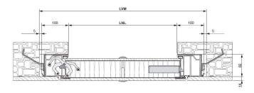
Dimensiones máximas que se pueden fabricar (LNLxLNH) 1200 x 2880 mm - Para un ancho máximo 1150 x 2900 mm - Para la altura máxima
